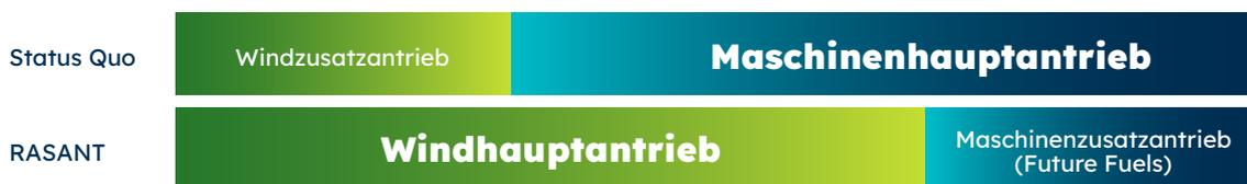
Ziel ist die Maximierung des Windantriebes (grün), um den Anteil des wasserstoffbasierten Maschinenantriebes (blau) zu minimieren.
